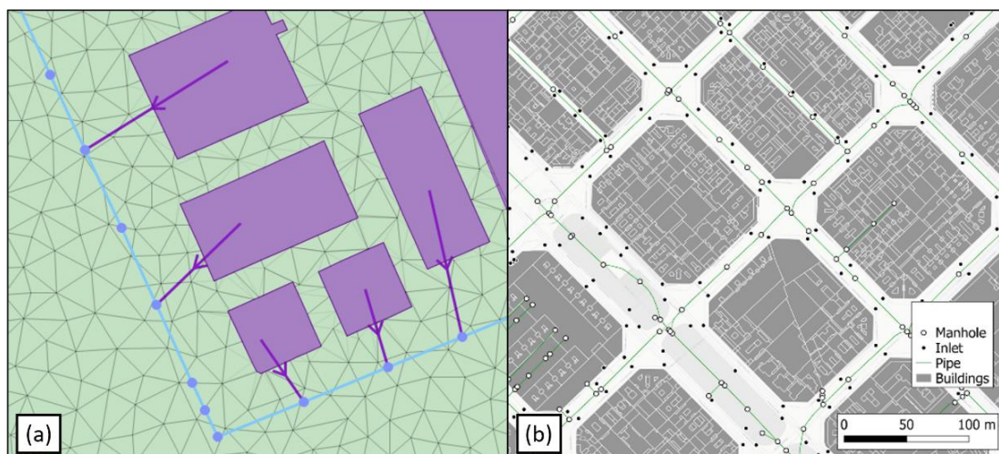
Figura 1 | Configuración del modelo 1D/2D: (a) estructura del modelo híbrido que muestra los elementos de malla 2D (triángulos verdes) y las áreas urbanizadas (polígonos morados); y (b) representación detallada de la red de drenaje y sus elementos principales.
